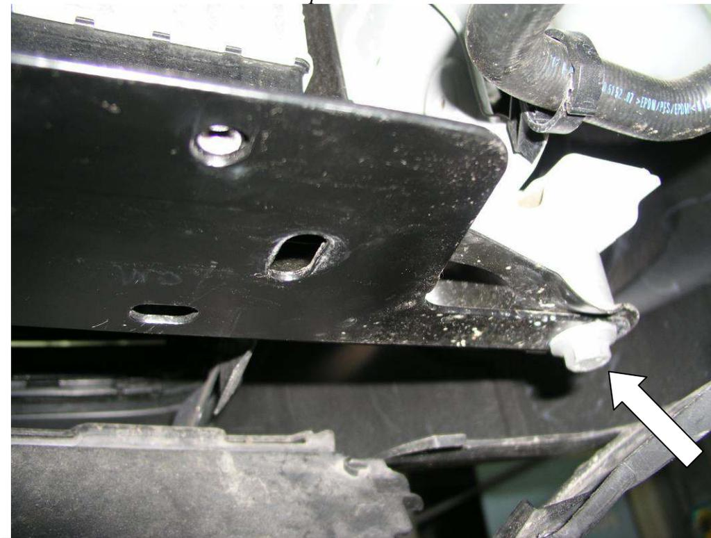
1. Снять передний штатный пыльник, который закрывает балку радиатора
